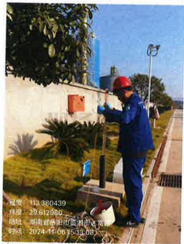
厂区下游监控井
